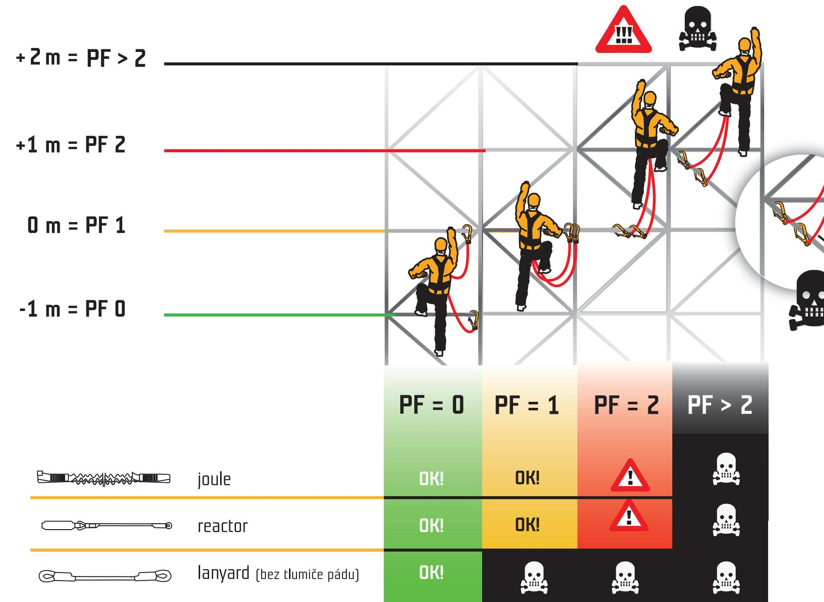
Při jištění výstupu za použití tlumiče pádu typu "Y" je nezbytně nutné se během výstupu pohybovat max. na úrovni PF 1 a nižší. Tzn., že spojky [EN362] spojené s tlumičem pádu [EN355] při výstupu "neklesnou" pod připojovací bod postroje [EN361], ve kterém je tlumič pádu připojen k postroji.
